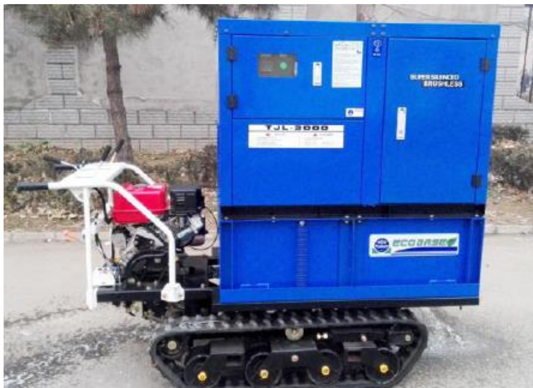
图 2.1-2 气味抑制剂 FD2 喷洒系统
